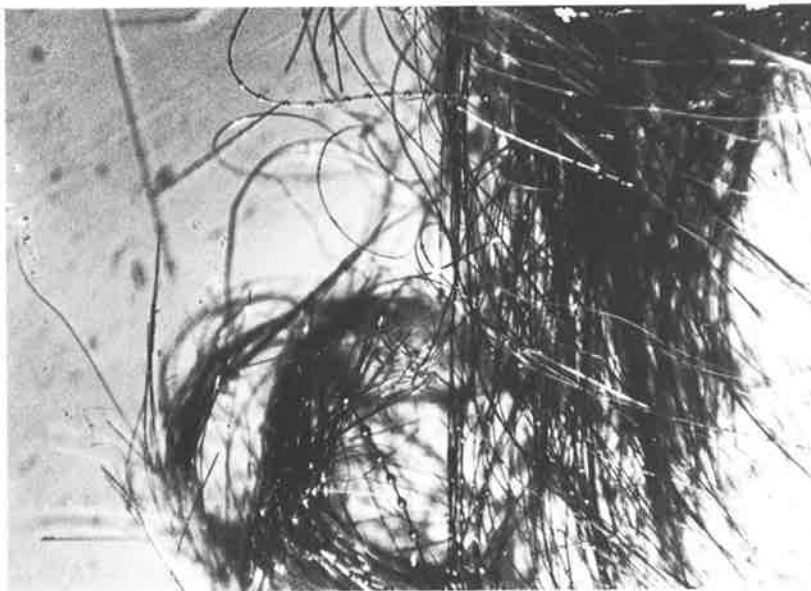
Bild 3. Am Institut gezüchtete NbSe 3 Faden-Einkristalle.
