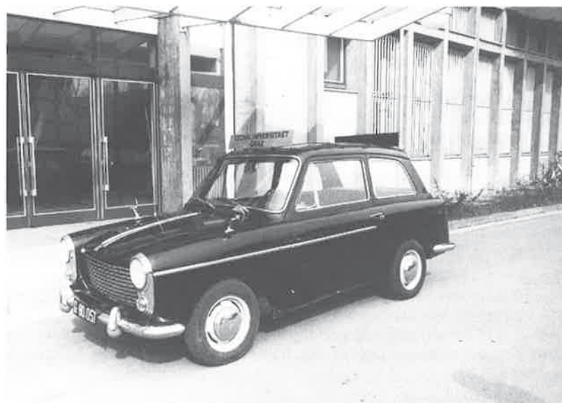
Bild 2 zeigt das Generator-Hybridfahrzeug des Institutes, das als fahrbarer Prüfstand für Batterien dient. Vom Öl unabhängige Brennstoffe, wie Alkohole, Ammoniak und Wasserstoff werden auf ihre Eignung als Antriebsmittel untersucht.
