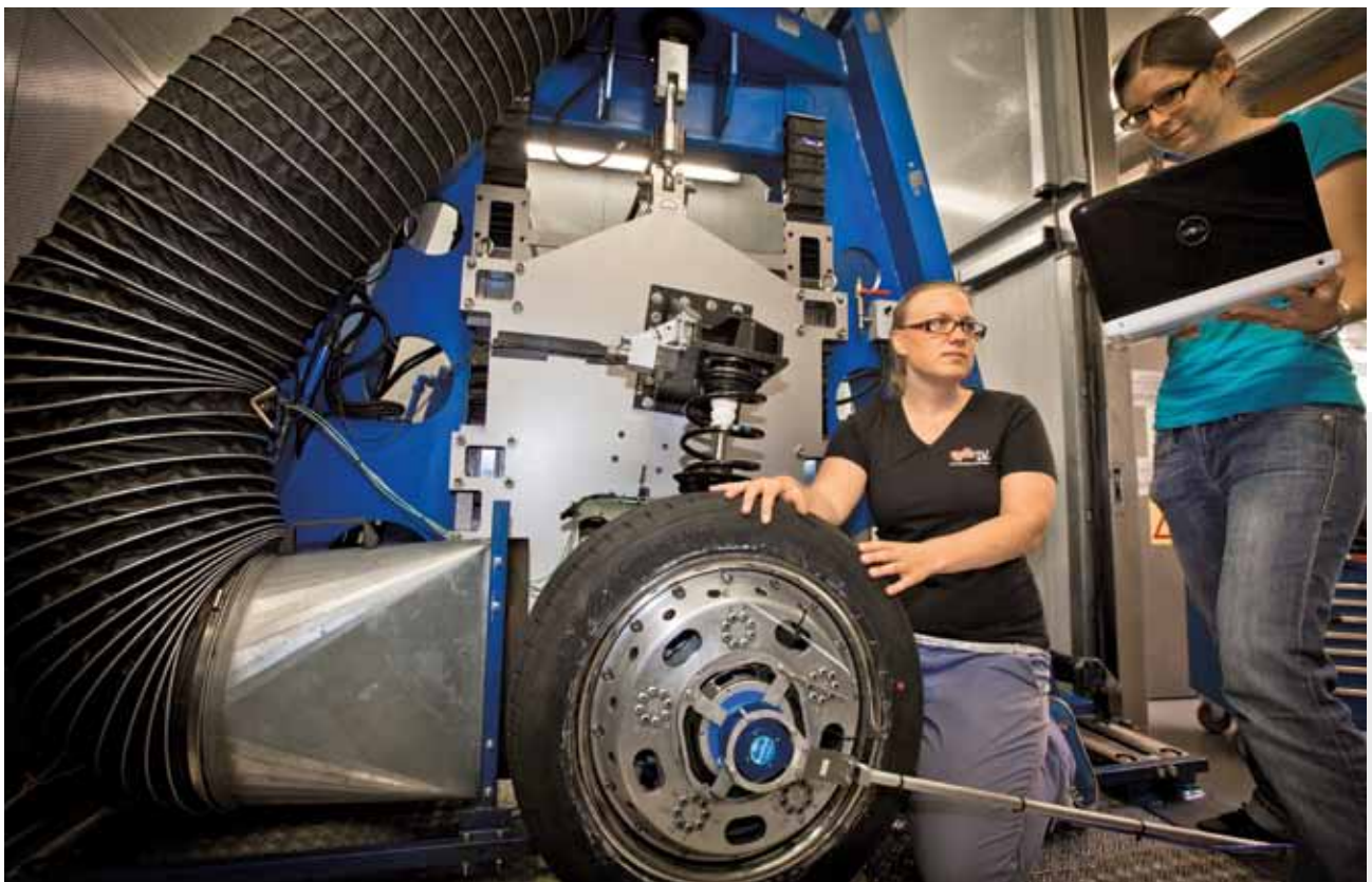
Schädigungstests am Fahrwerksprüfstand am Institut für Fahrzeugtechnik Carrying out damage tests using the suspension test rig at the Institute of Automotive Engineering
