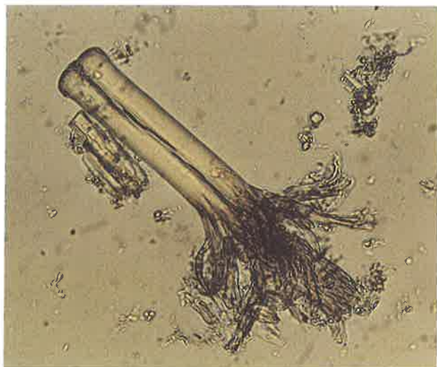
Abb. 1: Modifikation von Polyacrylnitrilfasern durch Mikroorganismen
