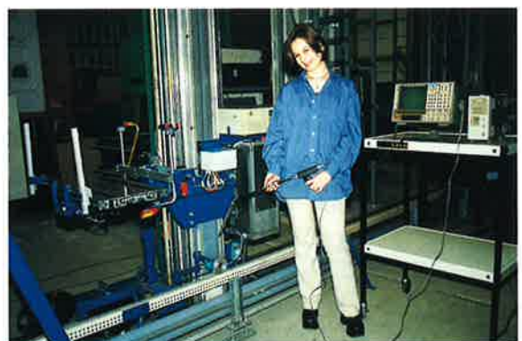
Mitarbeiterin bei einer Schallintensitätsmessung am Prototyp des am Institut für Allgemeine Maschinenlehre und Fördertechnik entwickelten Regalbediengerätes
