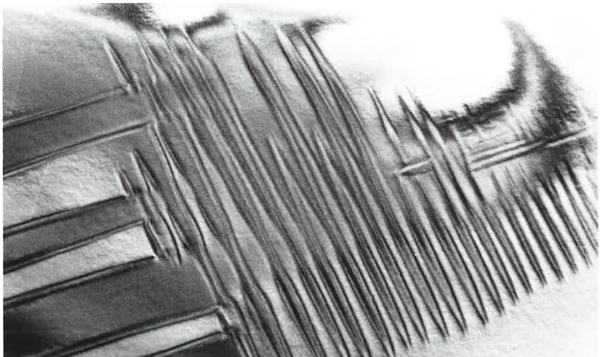
Bariumtitanat BaTiO 3 -Ceramik, Ferroelektrische Domäne, 103.109-fache vergrößert
