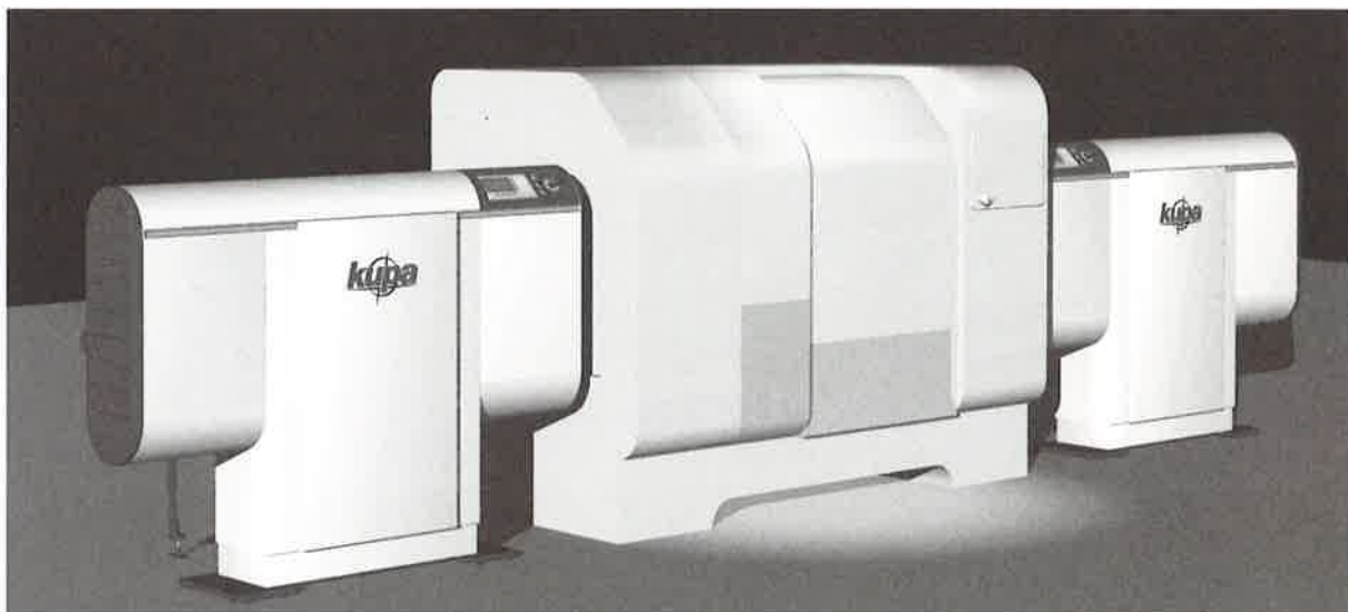
KUPA Stangenbe- und Entladesystem an einer CNC-Drehmaschine
