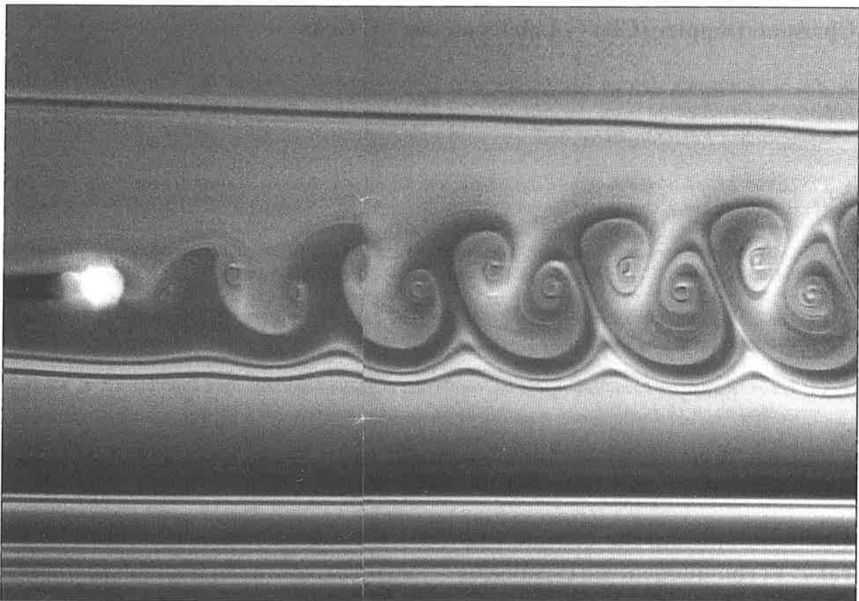
Abb. 5.5: Wirbelablösungen veranschaulicht an mit Rauch versetzter Luft im Windkanal: Auslöser ist ein in die Strömung eingeschobener Leiterdraht, hinter dem eine Wirbelstraße entsteht. Auf Freileitungsanlagen mit ungenügenden und falsch platzierten Dämpfungseinrichtungen führen solche und ähnliche durch Wind hervorgerufene Wirbelablösungen zu gefährlichen Leiterschwingungen. (Foto: Wolfgang Volz, Bilderberg)
