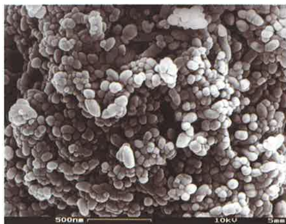
Pharmazeutisches Kalziumkarbonat (Feldemissionsrasterelektronenmikroskop Zeiss DSM982 Gemini)
