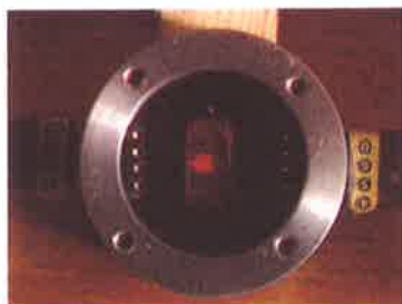
Rot-grün-blau (RGB) Farben, erzeugt von einer blauen organischen lichtemittierenden Diode (OLED) mit der neuen Farbwandlertechnik. Die Originalgröße der leuchtenden Quadrate ist 3 mm x 3 mm. Die Helligkeit der grün-leuchtenden Fläche entspricht der Helligkeit einer kommerziellen 20 W Leuchtstofflampe.
